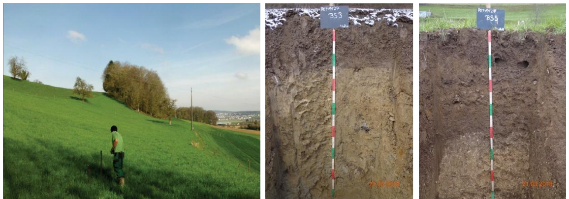
Abb. 12 Erhebung des bodenkundlichen Ausgangszustandes mit Bohrstocksondierungen und Baggerschlitzprofilen (10.04.2018, Fotos Terre AG)
